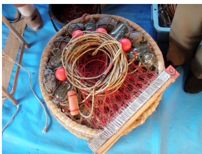
図7 ザル 1ザルで幹縄 40m 程度。針 100 本、浮子と重りの石が針 10 本毎に付く。
