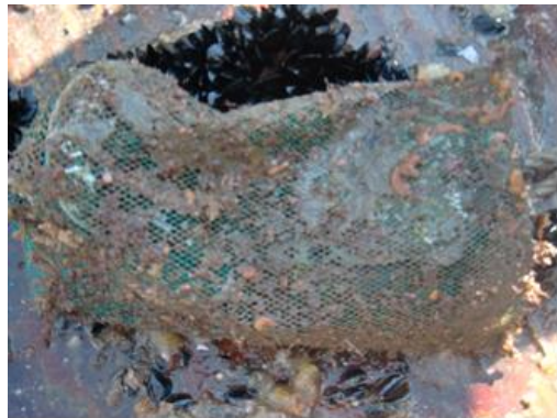
写真 11 防汚剤無処理ネット被覆区 (ネットにはやや多量の群体ボヤ)
